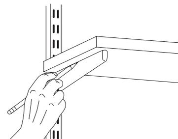
4 Расположить в последовательности сборки полки согласно произведенных разметок (рис.4);
